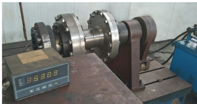
剪切管切断测试
