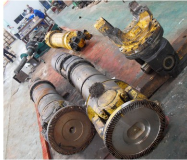
进口万向节到公司维修
