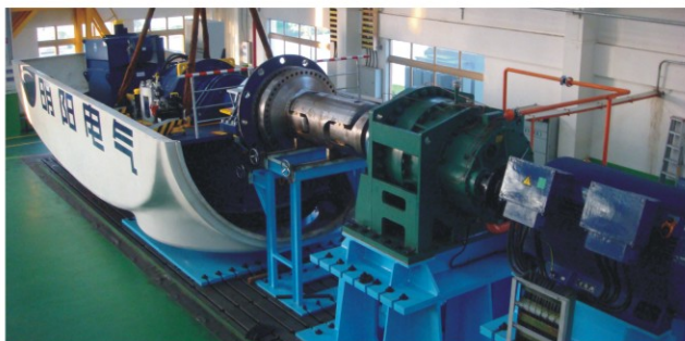
我们研发的碳纤维联轴器 现已通过实验验证， 可以满足客户要求，按需定制
