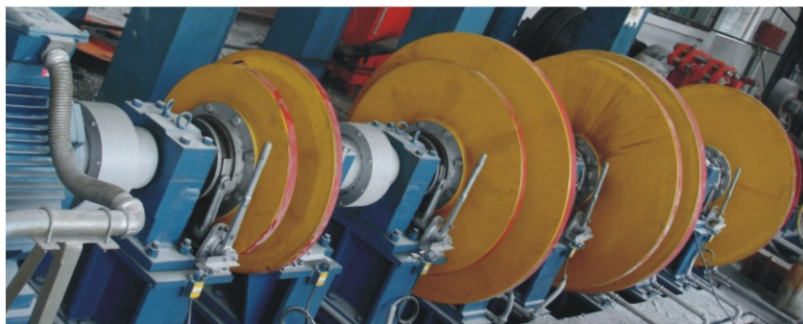
制动盘/轮系统测试台
