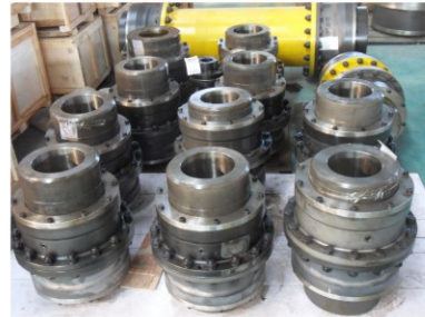
氮化后的齿轮联轴器
