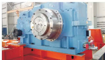
卷筒联轴器安装在减速机上
