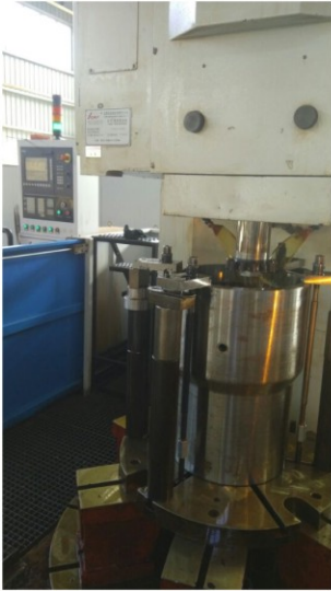
高位数控插齿机 (M20模数/高度1250mm)
