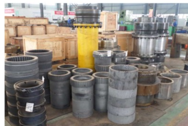
钢厂经过热处理氮化的齿轮
